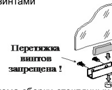
Перетяжка винтов запрещена! Схема сборки стеклянных дверей
